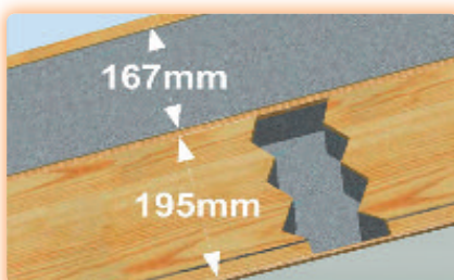
Keine Wärmebrücken, U-Wert 0,09 W/m 2 ·K
